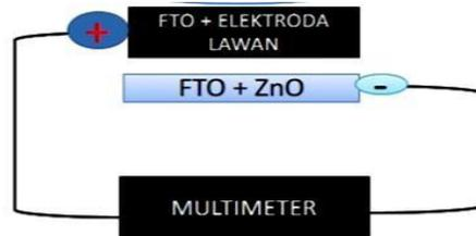
Gambar 2. skema rangkaian listrik pengujian sel surya.
