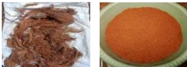
Gambar 1. Sabut yang telah dikeringkan (kiri) dan sabut yang telah dihaluskan (kanan)
