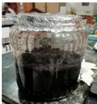
Gambar 2. Serbuk sabut kelapa yang direndam dengan NaOH
