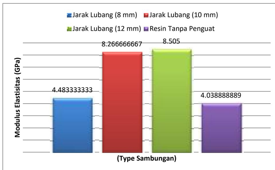
Gambar 4.11 Perbandingan Modulus Elastisitas Spesimen Komposit
