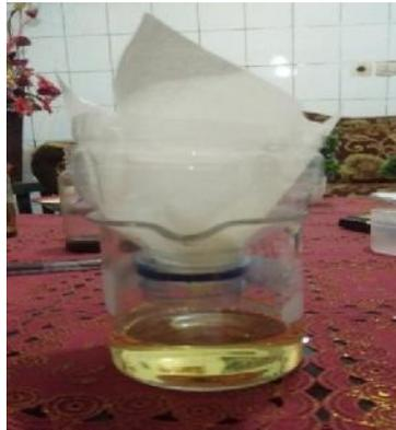
Gambar 14. Hasil penyaringan setelah didiamkan dengan zeolit dan alginat
