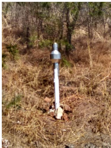
Gambar 5. Perangkat penakar curah hujan sebagai tools calibration di lokasi ( Pilot Project )
