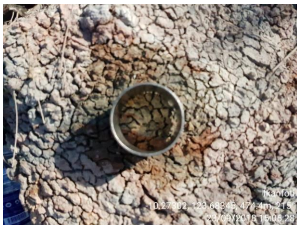
Gambar 7. Pengambilan sampel untuk analisis kerapatan isi dan menghitung porositas
