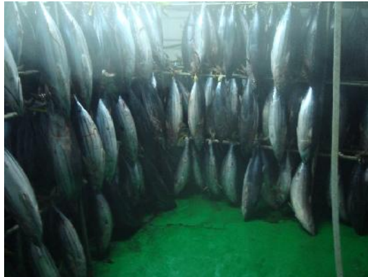
Gambar 1. Batch air blast freezer di mana ikan digantung di rak untuk dibekukan dalam ruangan dengan udara dingin.
