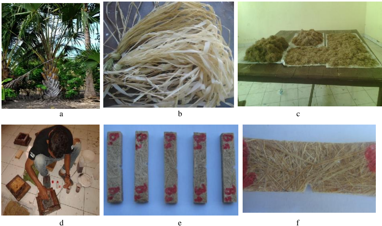
Gambar 1. a. Pohon Gewang, b. Serat Pucuk Daun Gewang, c. Serat yang telah dipotong-potong, d. Proses Pencetakan komposit, e dan f, Spesimen Uji Impak
