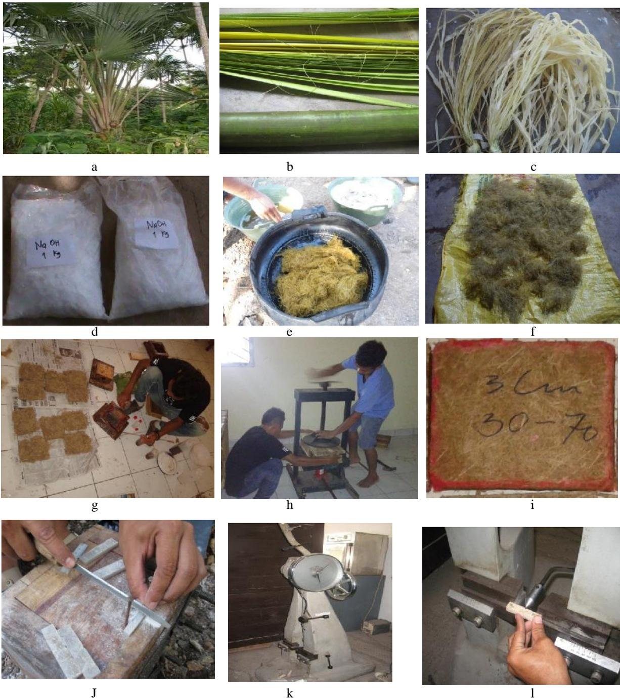
Gambar 1. *a.* Pohon Gewang, *b.* Pucuk Daun Gewang, *c.* Serat Gewang, *d.* NaOH, *e.* Perlakuan NaOH pada Serat, *f.* Serat dijemur setelah perlakuan NaOH, *g.* Serat ditimbang, *h.* Penekanan Cetakan, *i.* Hasil Cetakan Papan Komposit, *j.* Pembuatan specimen uji Impak, *k.* Alat uji impak, *l.* Uji Impak Spesimen
