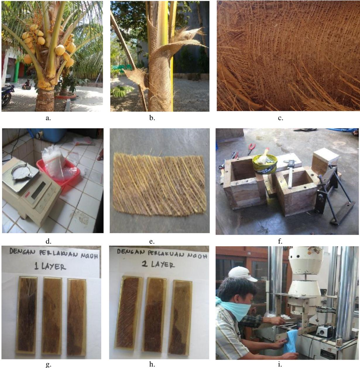
Gambar 1. a. Pohon Kelapa, b. Tapis Kelapa, c. Serat Tapis Kelapa, d. Penimbangan NaOH, e. Serat Tapis Kelapa yang telah diberi perlakuan alkali 5%, f. Cetakan dan Wax Mirror Glass, g dan h. Spesimen Uji, i. Pengujian Spesimen menggunakan alat UTM
