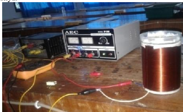
Gambar 3.2 Rangkaian solenoida yang terhubung dengan transformator dan posisi cawan petri saat perlakuan
